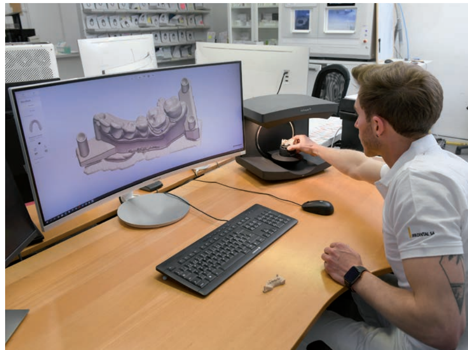
^ Zahnabdrücke können mithilfe eines 3D-Scanners digitalisiert werden.
